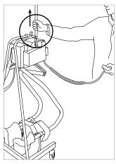
Lassen Sie den Griff des Umhängelifters in seiner Halterung einrasten. Achtung: Sie müssen noch etwas am Band ziehen, während Sie auf den unteren Knopf der manuellen Bedienung drücken, um den Umhängestab zu entfernen.
