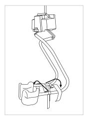
Hängen Sie die Beinstützen über den gegenüberliegenden Arm des Hebebügels.
